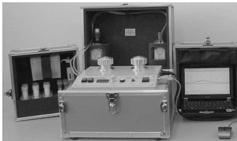
Рис. 1. Рентгенофлуоресцентный анализатор с сорбционной накопительной микросистемой.
